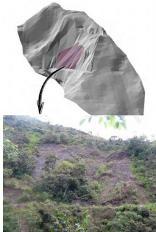
Figura 19. Esquema del proceso de Desprendimiento
