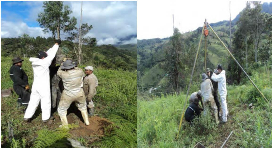
Fotografía 1. Exploración directa del subsuelo (SPT)
