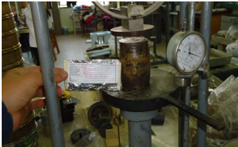
Fotografía 25. Muestra fallada en el ensayo de compresión no confinada.
