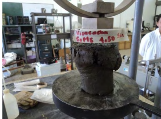
Fotografía 18. Muestra fallada en el ensayo de compresión no confinada.
