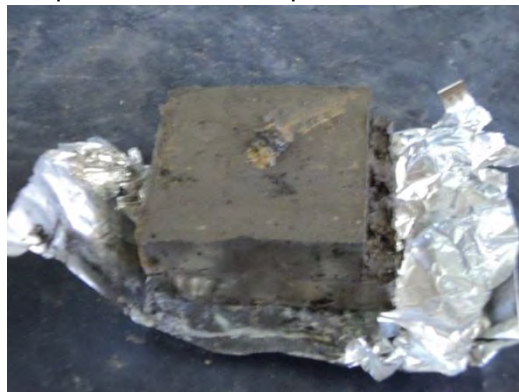
Fotografía 19. Muestras a las que se les realizó la prueba de corte directo.
