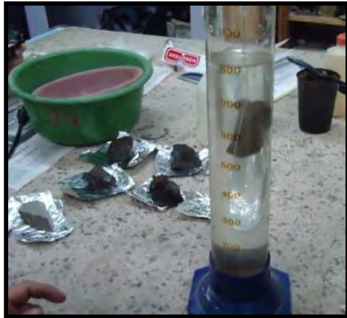
Fotografía 22. Medición de volumen de la muestra para establecer propiedades físicas de la roca.
