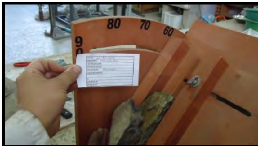
Fotografía 25. Ensayo de Tilt Test
