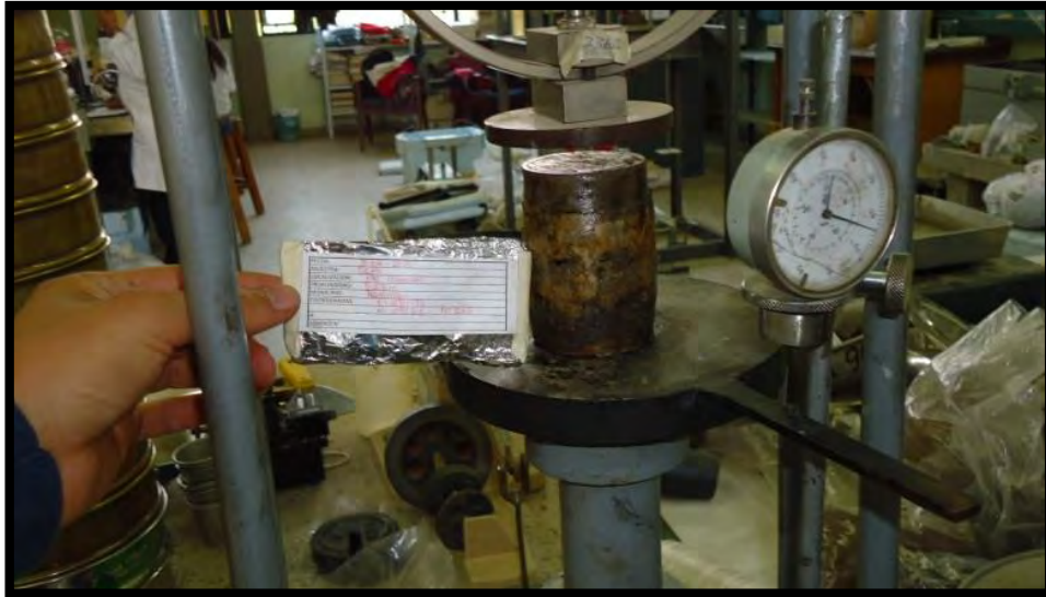
Fotografía 23. Muestra fallada en el ensayo de compresión no confinada.
