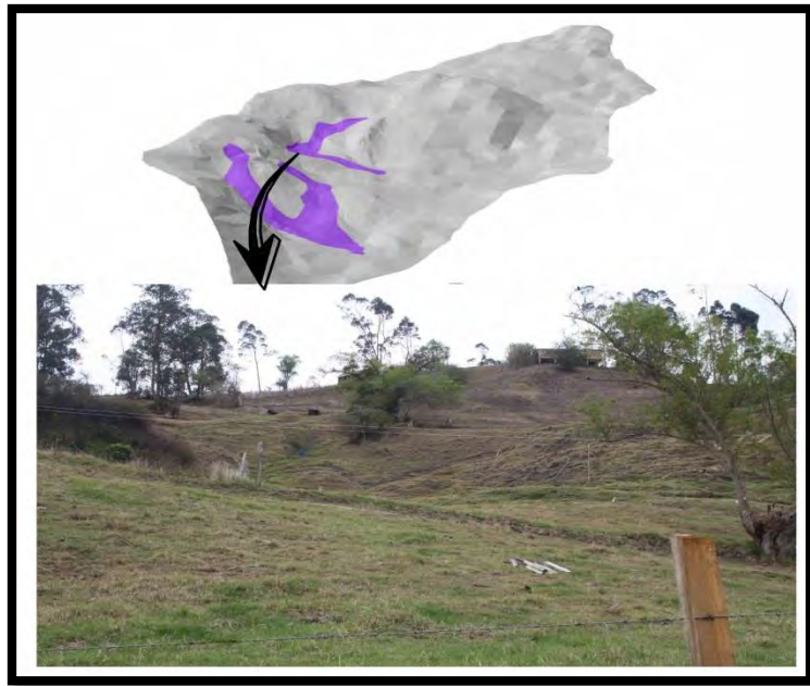
Figura 9. Esquema del movimiento, reptación 1
