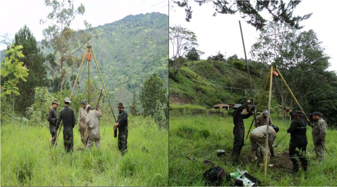
Fotografía 1. Exploración directa del subsuelo (SPT)
