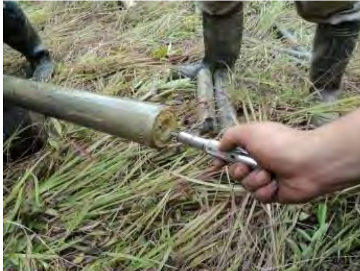
Fotografía 19. Prueba de Penetrometro de Bolsillo
