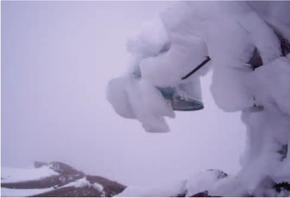
Figura 9. Recipiente que contiene el sensor de temperatura, cables y soportes cubiertos totalmente por hielo. Estación Kumanday (Mejía & Botero, 2008).
