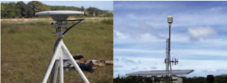
Figura 3 Antena GPS y sensor meteorológico asociado en la estación SAN0.
