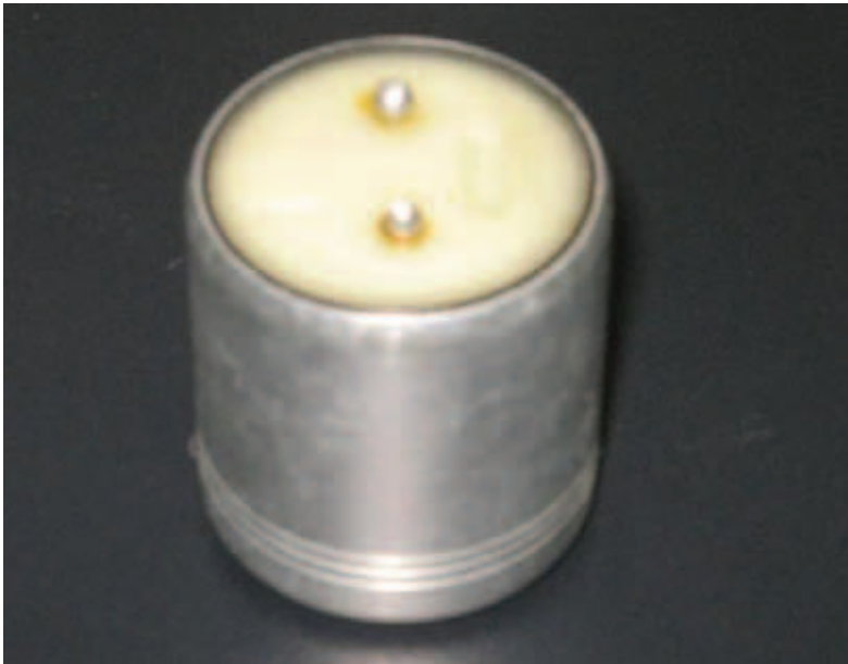
Foto 3. Geófono L4-10B, utilizado en las estaciones monitoras de flujos de lodo.
