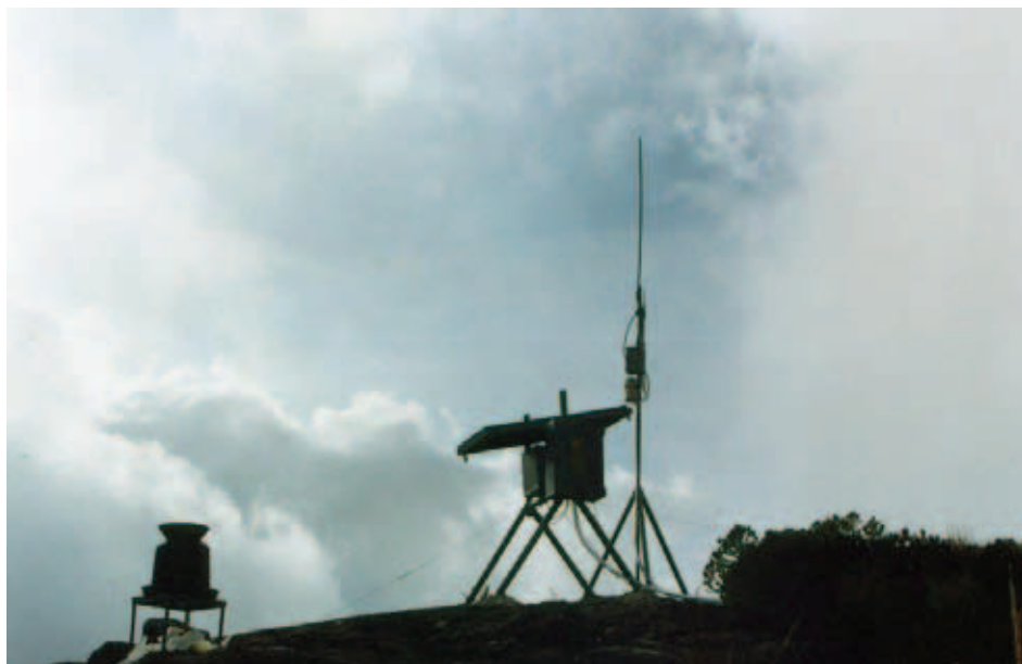
Figura 2. Estación hidrometeorológica Molinos (Nevado del Ruiz). Tomado de UNAL-UC, 2004.
