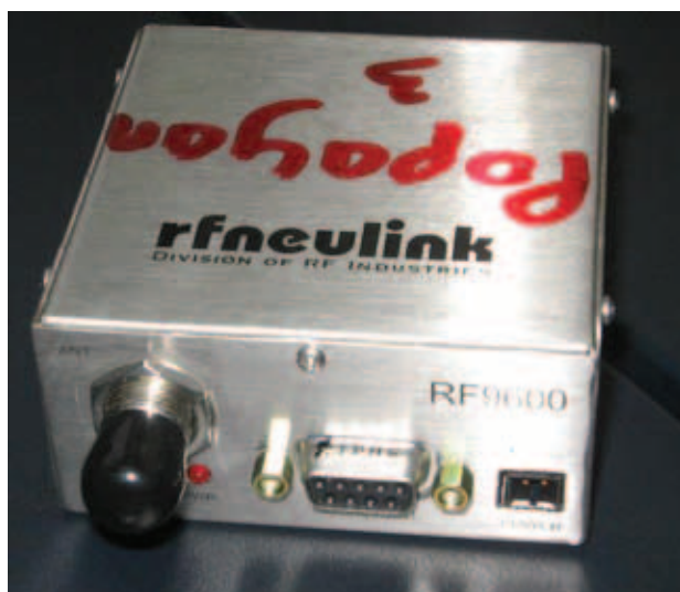
Foto 5. Radio transceiver usado para la transmisión de datos y comunicación con la estación.
