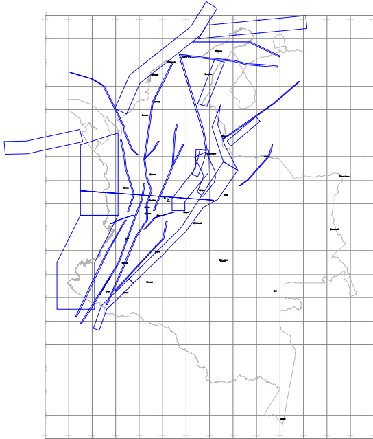
Figura 2 Fuentes sismogénicas superficiales
