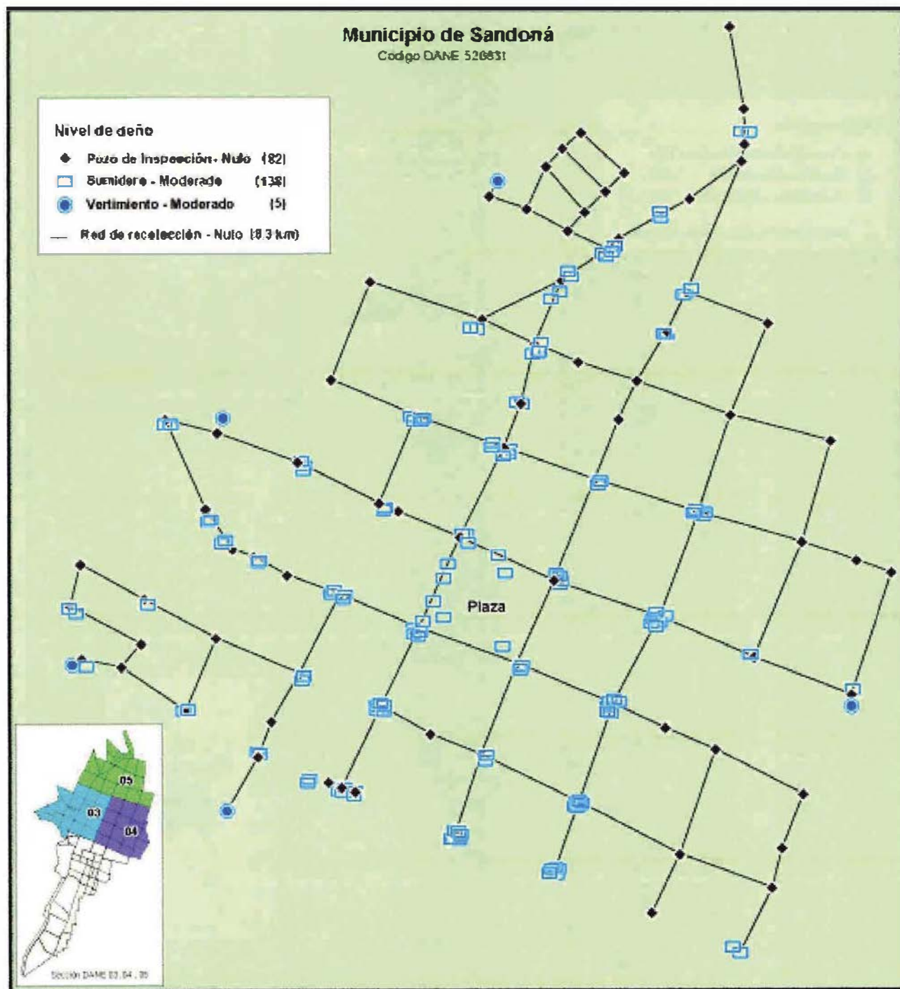
Figura 19. Distribución de daños potenciales en el sistema de alcantarillado por caída piroclástica -Municipio de Sandoná
