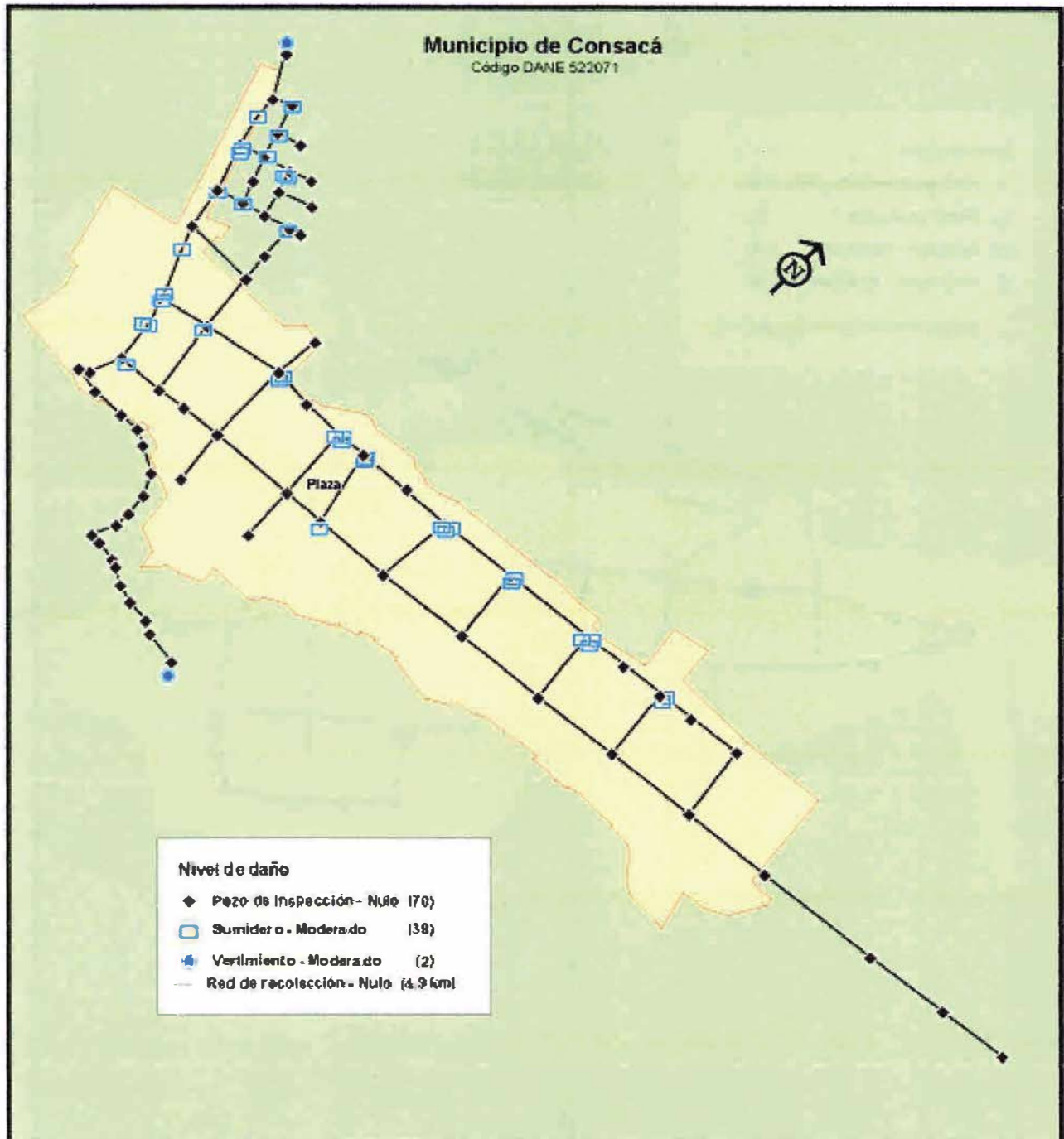
Figura 7. Distribución de daños potenciales en el sistema de alcantarillado por caída piroclástica.- Municipio de Consacá
