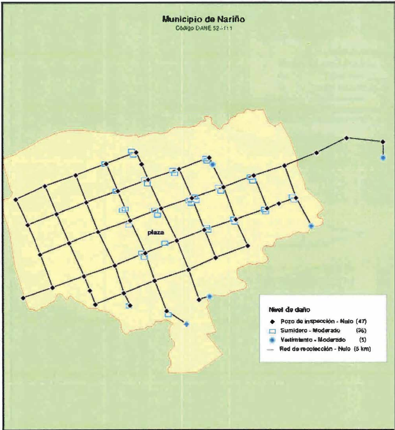
Figura 12. Distribución de daños potenciales en el sistema de alcantarillado por caída piroclástica –Municipio de Nariño
