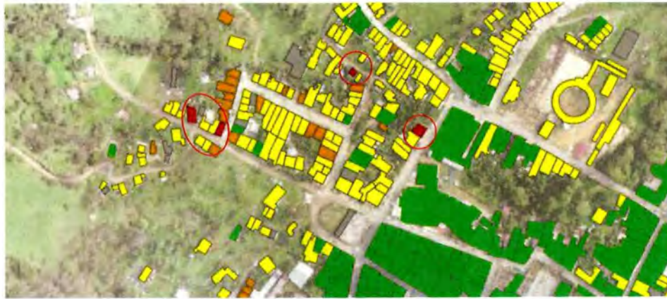
Figura 60. Ubicación edificaciones categorizadas en Riesgo alto mitigable, SECTOR 1/ Zona Urbana y suburbana.
