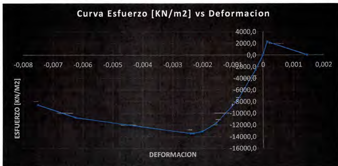
Figura 110. Curva Esfuerzo vs Deformación del concreto, según formulación de Takeda.
