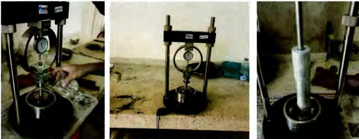
Figura 39. Vista general de ensayos de presión de expansión.
