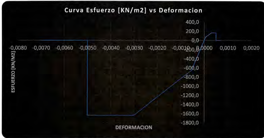
Figura 109. Curva Esfuerzo vs Deformación de la mampostería.
