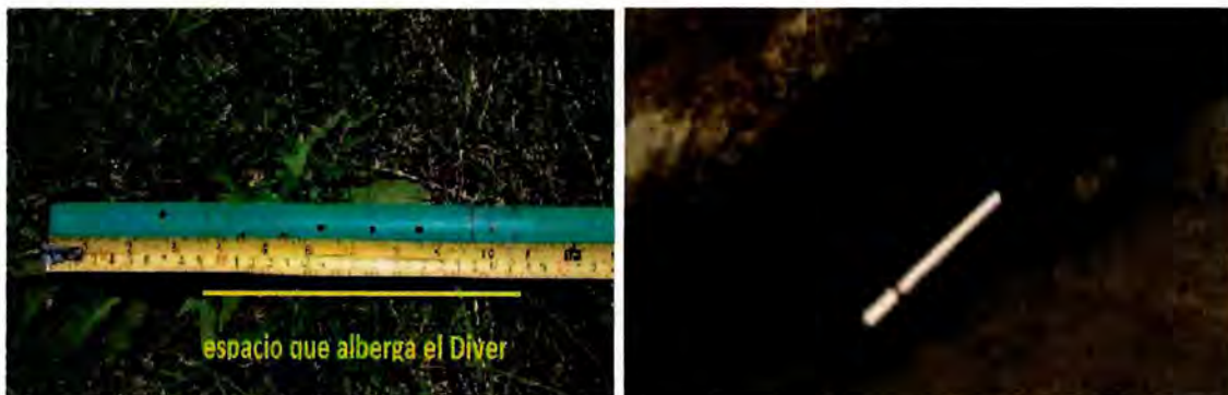
Figura 177. Dispositivo construido para el slug test y Baro Diver.
