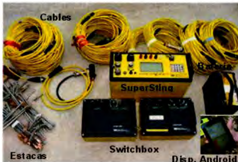
Figura 1. Vista del equipo SuperSting R/8 usado en la exploración geotécnica
