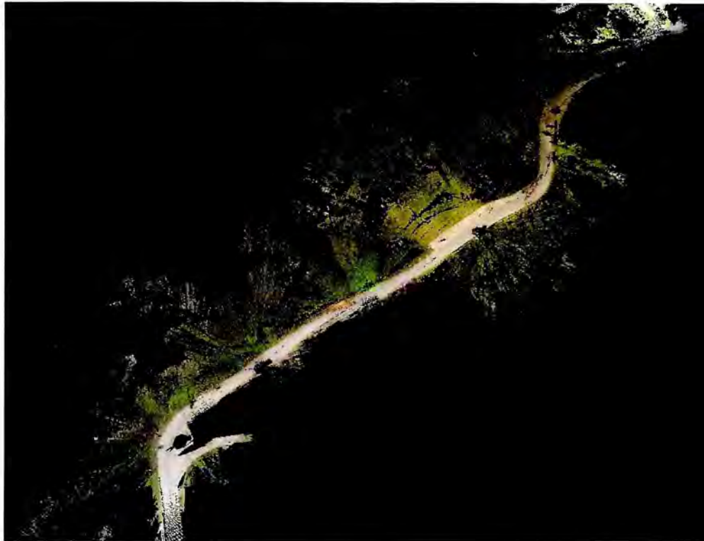
Figura 35. Nube de puntos filtrada del sector urbano sobre la vía nacional desde la entrada de la escuela de la policía hasta la intersección con transversal 3
