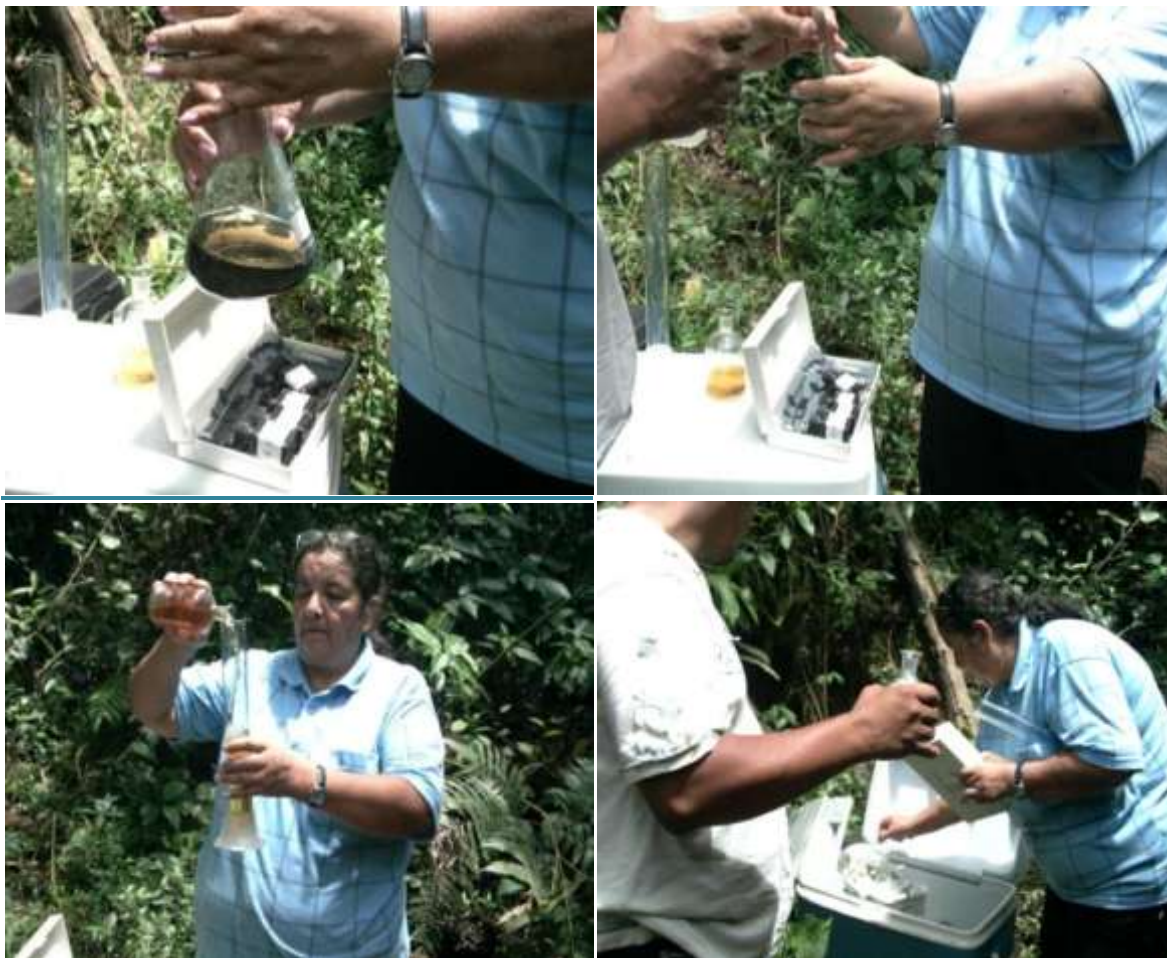
Figura 4. Procedimiento de aplicación de reactivos para determinar el DBO5 en la muestra de la parte alta del río Timaná
