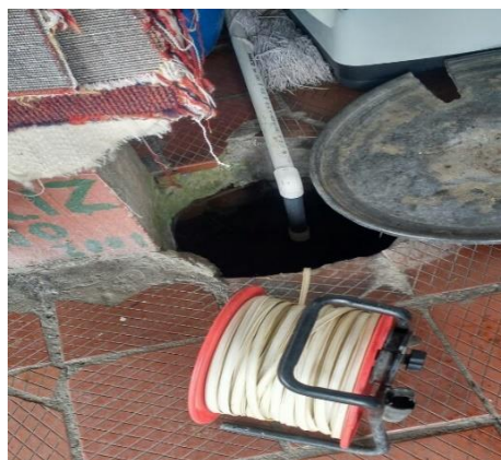
Fotografía 14. Medición de la altura de la lámina de agua.
