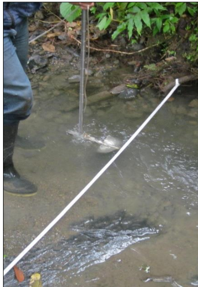
Figura 5.219. Aforo de Caudal, Río Chivor punto 41
