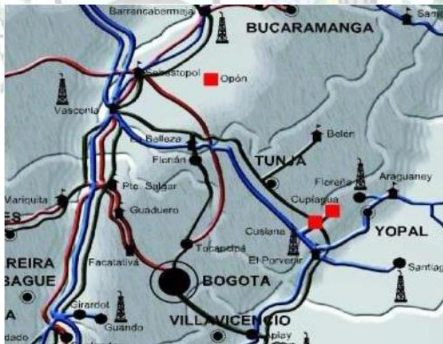
Fig. N°2 Diagrama sistemas de transporte de hidrocarburos Boyacá
