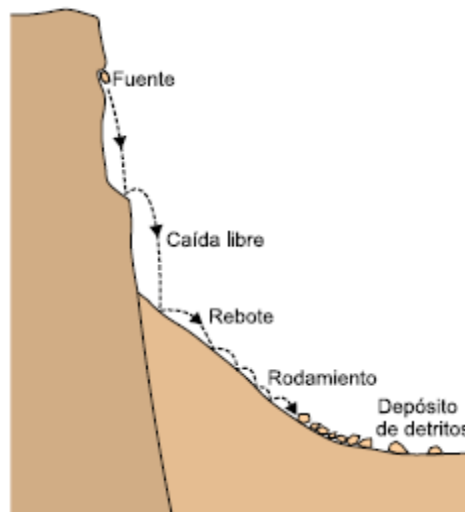
Ilustración 2. Esquema de caída de rocas. Tomada de (Proyecto Multinacional Andino: Geociencias para las Comunidades Andinas, 2007).
