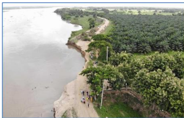
Fig. 1 y 2. Erosión fluvial en la vía Salamina - El Piñón, departamento del Magdalena. Fuente: UNGRD, 2020.
