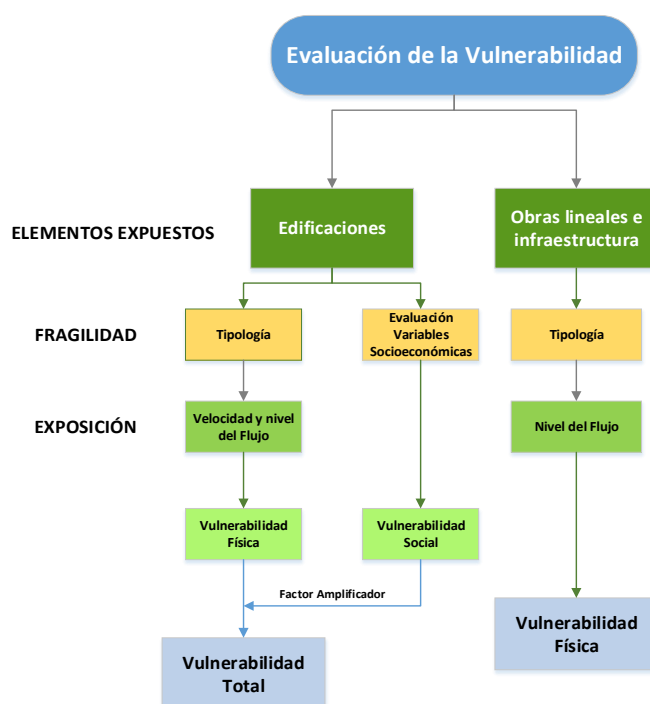
Figura 24 Esquema metodológico vulnerabilidad Edificaciones y obras lineales e infraestructura Fuente: GEOCING S.A.S 2017
