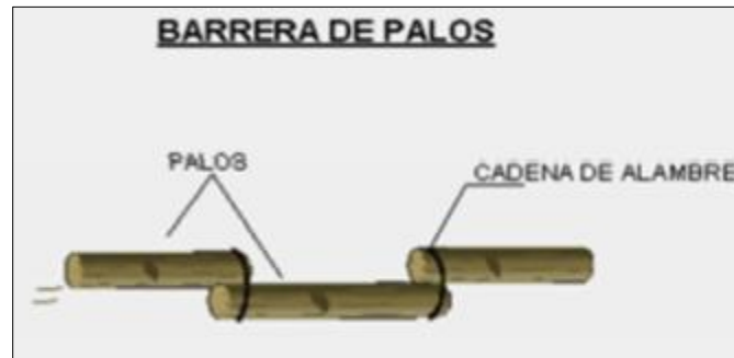
Ilustración 20: Barreras de tablas y palos para la contención de derrames
